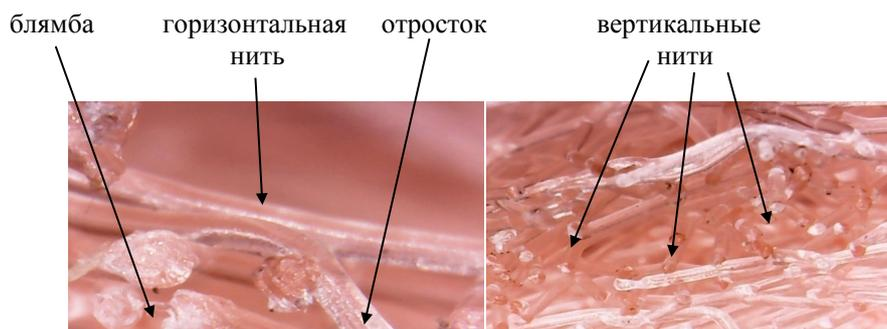
Рис. 4. Фотоснимки внутренней структуры картриджа
