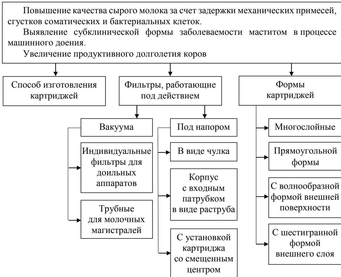
Рис. 2. Высокотехнологические разработки фильтров сырого молока
