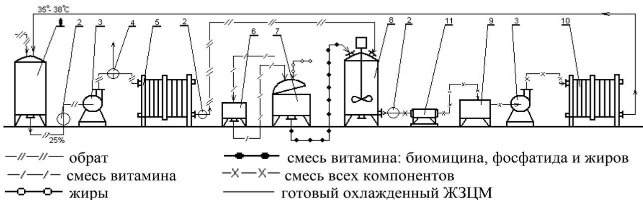
1 – танк-смеситель № 1; 2 – кран 2-ходовой; 3 – насос; 4 – кран 3-ходовой; 5 – пастеризатор; 6 – смесительная ванна; 7 – варочный котел; 8 – танк-смеситель № 2; 9 – диспергатор-гомогенизатор; 10 – охладитель; 11 – фильтр
